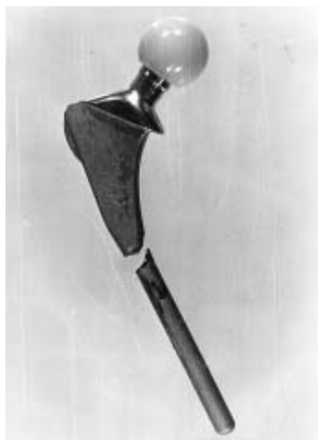
Figura 7. Imagen del vástago femoral roto extraído. La superficie de fractura del vástago muestra deformación y pérdida de material consecuencia de la fatiga del implante.
