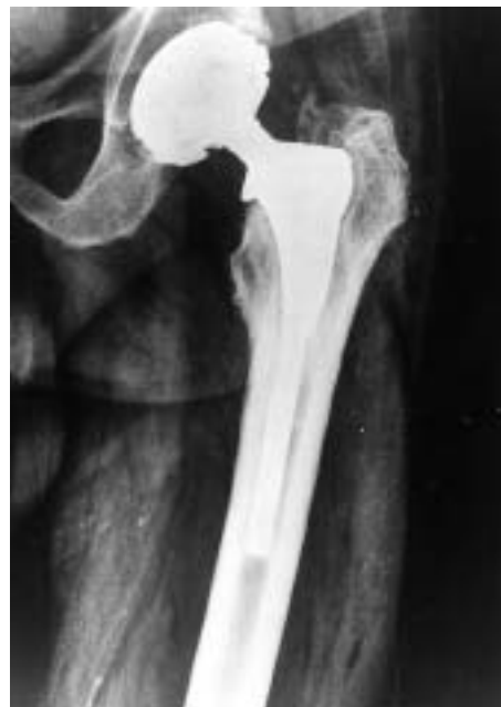
Figura 3. Radiografía correspondiente al segundo caso en la que se observa el fallo del vástago femoral a nivel de la transición de la sección cónica a la cilíndrica.
