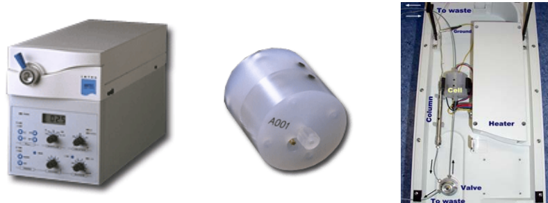
Figura 28. Detector electroquímico (INTRO), celda electroquímica (VT-03/ISAAC) y montaje
