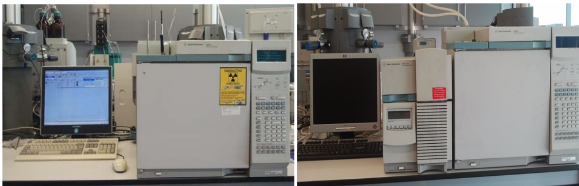
Figura 27. Cromatógrafo de gases 6890N con ECD y FID, y cromatógrafo de gases con detector de espectrometría de masas, de Agilent Technologies.
