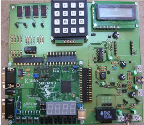
Fig. 1. Placa de expansión con placa Spartan3 incorporada.
