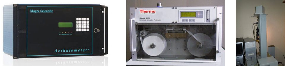
Figura 2.2: Instrumentación empleada para obtener y corregir las medidas de absorción: a) etalómetro AE31, b) MAAP 5012 y c) nefelómetro de integración TSI 3563.
