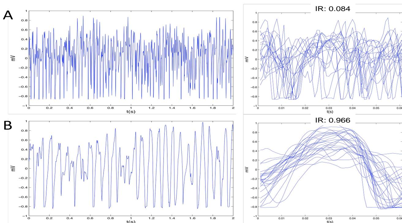
**Figura 1.** Ejemplo de valores obtenidos para IR. Los gráficos de la izquierda muestran la señal de FV, y los de la derecha una superposición de las OAL detectadas. IR es mayor cuando la forma de las OAL es más regular (B).
