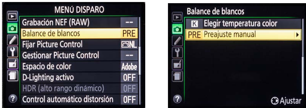
28. Con una cámara Nikon, en el Menú Disparo se selecciona el Balance de blancos PRE. © Ricardo Guixà
