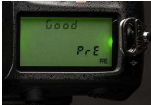
29. Presionar el botón WB (a la izquierda de la pantalla posterior), seleccionar un preajuste (d-1 a d-4) soltar y volver a presionar, hasta que parpadee “PRE” en la pantalla superior. © Ricardo Guixà
