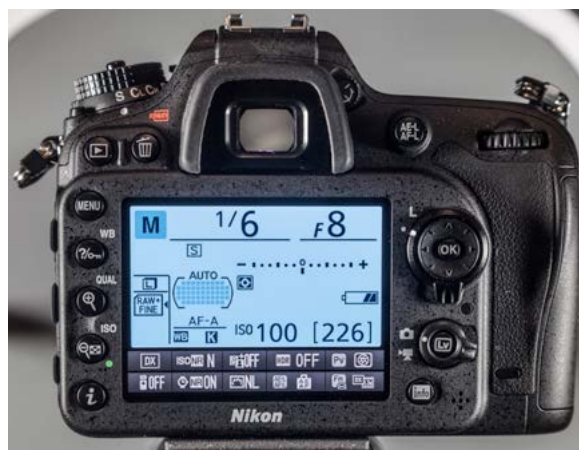
20. Configuración recomendada en una cámara Nikon D7100. El tiempo de obturación dependerá de la luz empleada. © Ricardo Guixà
