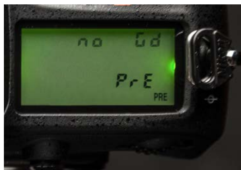
30. Seguidamente hacer la fotografía del gris medio o del blanco estándar iluminado con la misma fuente de luz que tenga el documento. Si la lectura es correcta, en la pantalla superior aparecerá escrito “Good” y, si no es correcta, “no Gd”. En el segundo caso, hay que repetir el paso anterior (figura 29). © Ricardo Guixà
