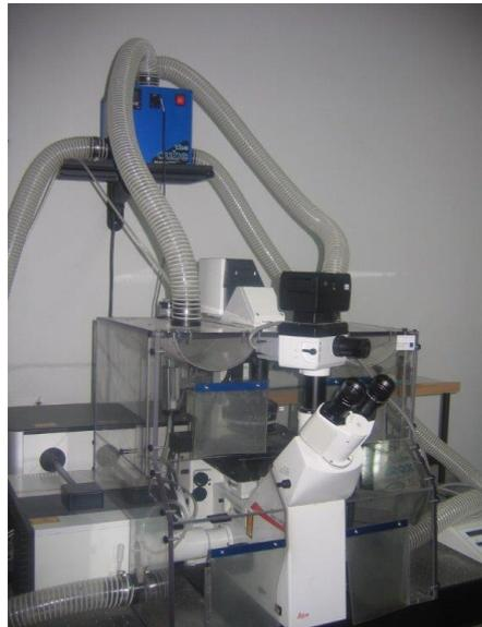
**Figura 8** – Microscópio confocal a laser
