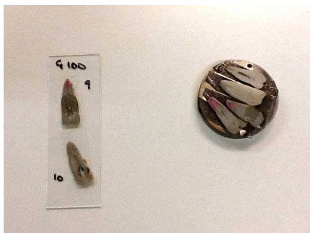
**Figura 10** – Exemplo de uma placa de vidro para observação ao microscópio confocal e suporte com cortes após metalização para observação no MEV.
