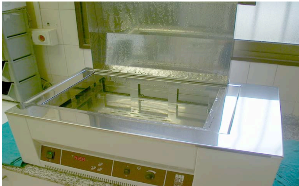
Figura 20. Baño termostático a 42°C donde se colocarían los criotubos en caso que fuese necesario su descongelación.
