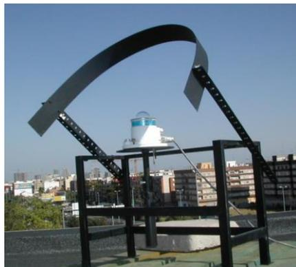
Figura 2.4.- Dispositivo experimental para la medida de la radiación UVER difusa.
