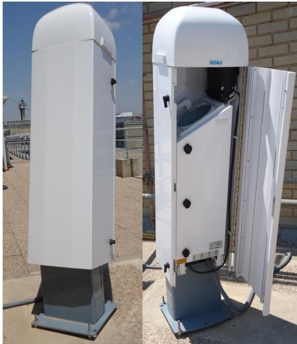
Figura 2.12.- Ceilómetro CL-51 de Vaisala.
