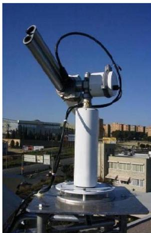
Figura 2.6.- Fotómetro CE-318 de Cimel en Burjassot (Valencia).
