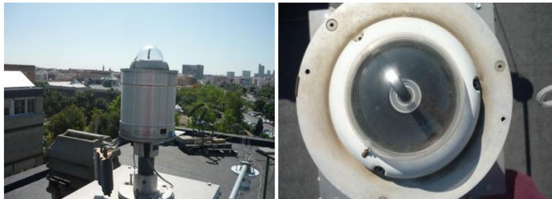
Figura 2.7.- a) Cámara de nubes SONA SIELTEC S.L. b) Detalle del círculo central con la banda de sombra sobre el sensor.
