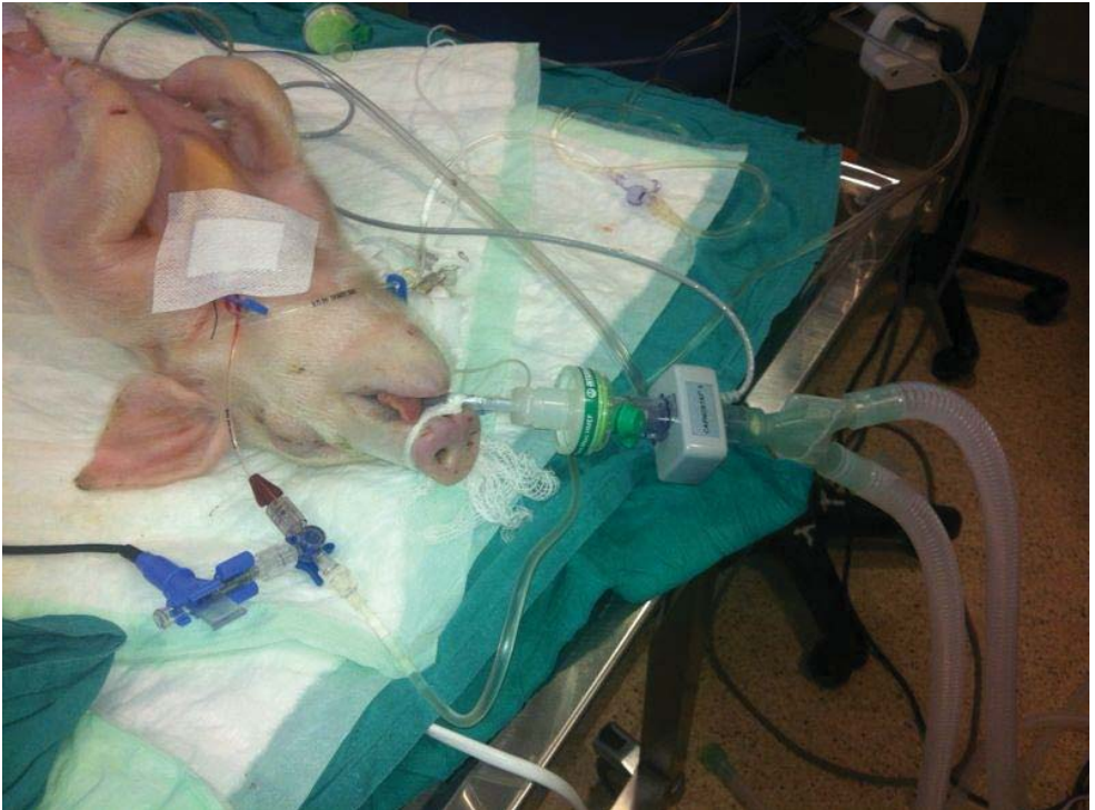
Figura 11. Sensor del monitor NICO. Sensor de capnografía tipo “mainstream” (single-patient airway adapter, neonatal: 6312-00) situado entre el tubo endotraqueal y la pieza en “Y” del circuito respiratorio.
