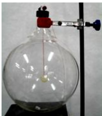
Figura 26. Botella de dilución estática (2 L) empleada para la generación de patrones gaseosos.
