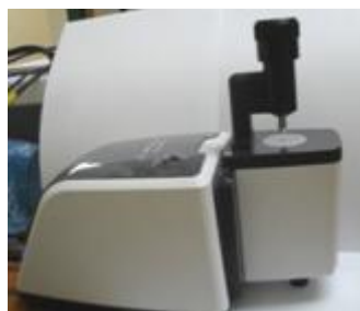
Figura 21. FTIR-ATR (Cary 630 FTIR)
