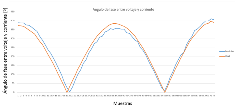
Fig. 8. 16.- Mediciones de diferencia de fase entre voltaje y corriente.
