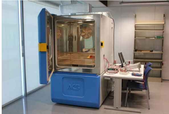
Fig. 5.1.- Vista frontal de la cámara climática mod. Angelantoni CH600.
