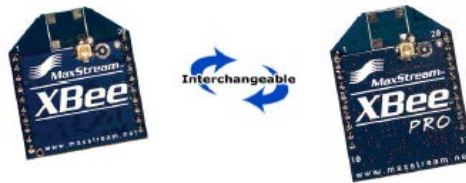
Fig. 1. 21.- Módulo regular y pro de la familia XBEE serie 2, [ 85].
