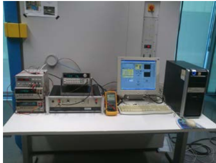
Fig. 5. 9.- Dispositivo experimental hardware-software diseñado para la caracterización térmica de los sensores.
