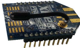
Fig. 8. 20.- Módulo XBEE serie 2 de Digi.
