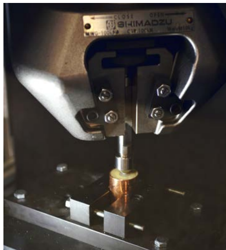
Fig. 28: ampliación de la zona del puntero con la bola de alúmina de la máquina Shimadzu® AGX 100 KN.
