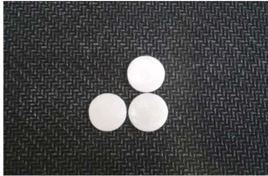
Fig. 21: discos de circona de los grupos ZP, Z y DZ una vez terminado su procesado.
