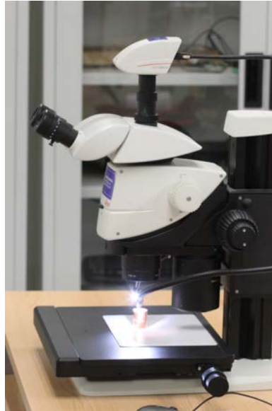
Fig.35: imagen de la instalación microscopio-cámara con la que se realizó la observación microscópica de las muestras fracturadas.
