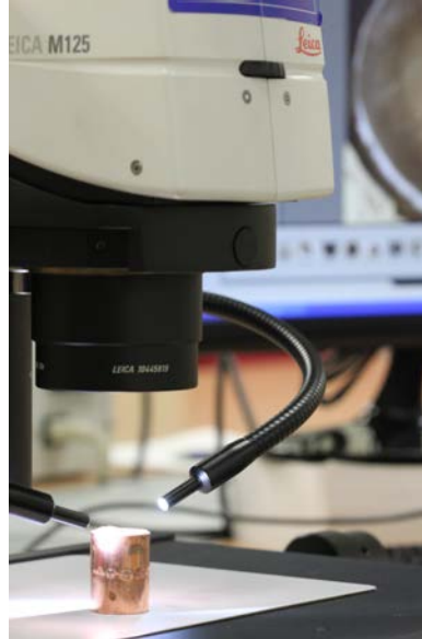
Fig.33: imagen del estéreo-microscopio Leica M125® con la iluminación Leica LED5000 SLI®, durante la observación de uno de los cilindros ensayados.
