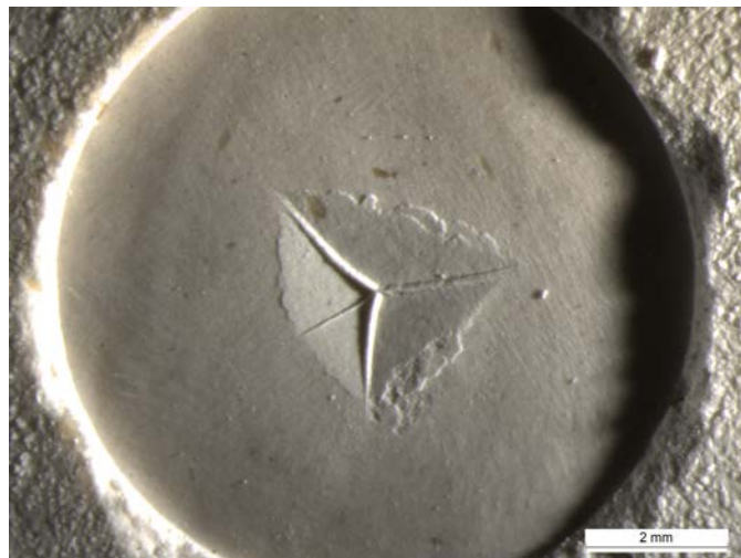
Fig. 45: imagen de la muestra Z10, con indentación del puntero en la escayola por desprendimiento de toda la circona.
