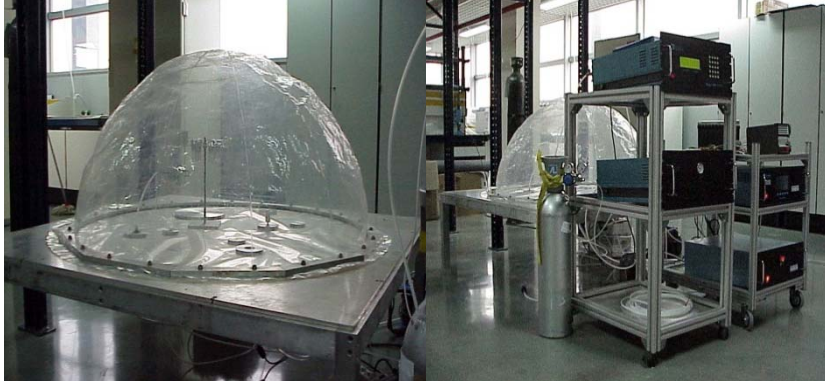
Figura III.1 Cúpula de teflón (imagen izquierda). Montaje de los equipos utilizados para realizar los experimentos (imagen de la derecha), el rack de la izquierda contiene una calibradora (DASIBI) y el de la derecha un monitor de H 2 S (DASIBI serie 4108A)
