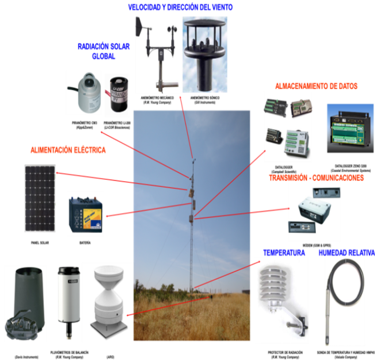
Figura 11.2 Esquema y especificaciones de los distintos sensores colocados en las torres meteorológicas de la red de datos meteorológicos del CEAM (torre tipo). Fuente: Red de Torres Meteorológicas de la Fundación CEAM, David Corell-Custardoy et al. II Jornades de la Meteorologia i Climatologia de la Mediterrànea Occidental - JMCMO. Póster
