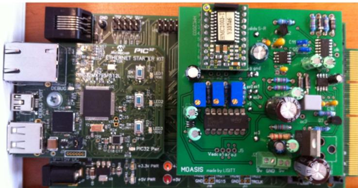
Figura 111. Dispositivo formado por el sensor AMR sobre una PCB acoplada a un dispositivo modular PIC 32.
