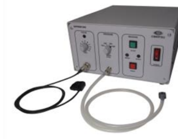
Pletismómetro modelo NIPREM 645 de Cibertec (Barcelona).
