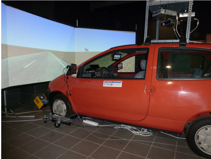
FIGURA 4.9: Vista exterior del simulador SIMUVEG
