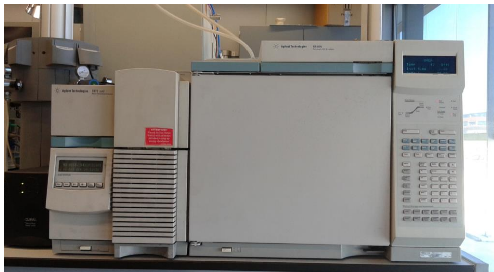
Figura 20. Equipo cromatógrafo de gases con detección de espectrometría de masas empleado para la detección de CDE.
