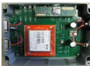
Imagen 31: Sensor BluFAX ("Traffax INC,," 2015)
