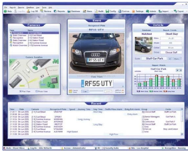
Imagen 5. Ejemplo tratamiento imágenes sistema ANPR (Empresa EDS)
