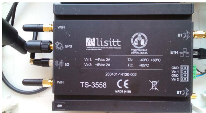
Imagen 39: Ejemplo sensor BLISITT
