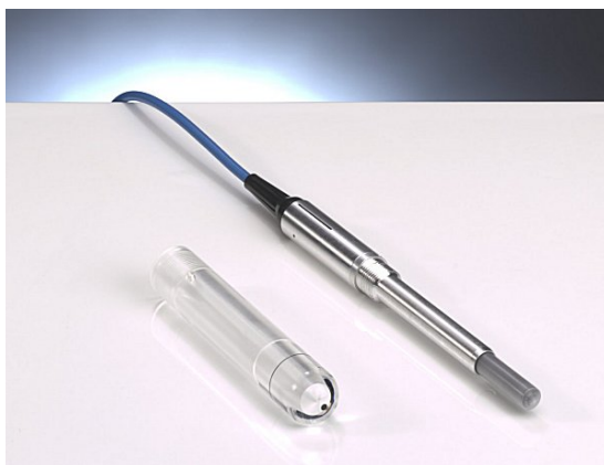
Fig. 4.4: cámara de ionización tipo Farmer, utilizado para las medidas de dosis absoluta.
