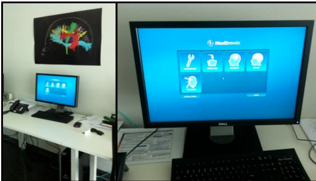
Figura 17: Planning Station Stealth Station S7 Medtronic ® , con software StealthViz ® y Cranial ® para planificación quirúrgica y cálculo de volúmenes tumorales.
