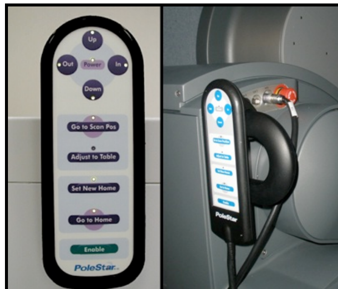
Figura 24: Unidad de control remoto (UCR) del gantry. Cada uno de los botones del mando de control se acompaña de una luz LED que se ilumina cuando el botón se encuentra habilitado. Para activar la UCR se debe de presionar el botón "Enable" simultáneamente con el botón que se quiera utilizar. Ambos pulsadores deberán mantenerse pulsados durante toda la duración del movimiento.
