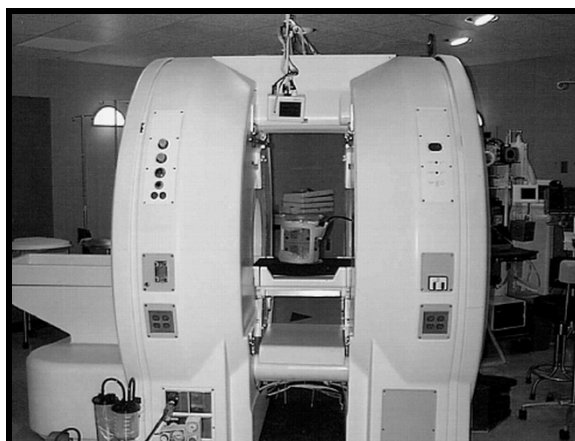
Figura 132: Diseño en doble donut de la RMi Signa SP de General Electric. Consiste en dos imanes superconductores separados por un espacio de 54cm que permiten el acceso al cirujano o enfermería. Está diseñado para su uso en ambientes quirúrgicos. Este equipo requiere instrumental RM seguro o RM compatible.
