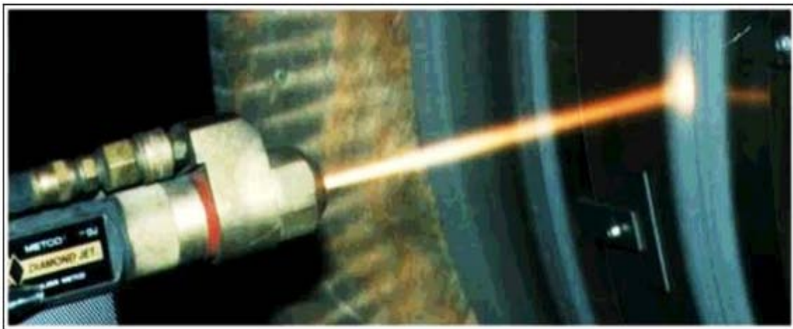
Apreciación de la llama de un equipo de alta velocidad.
