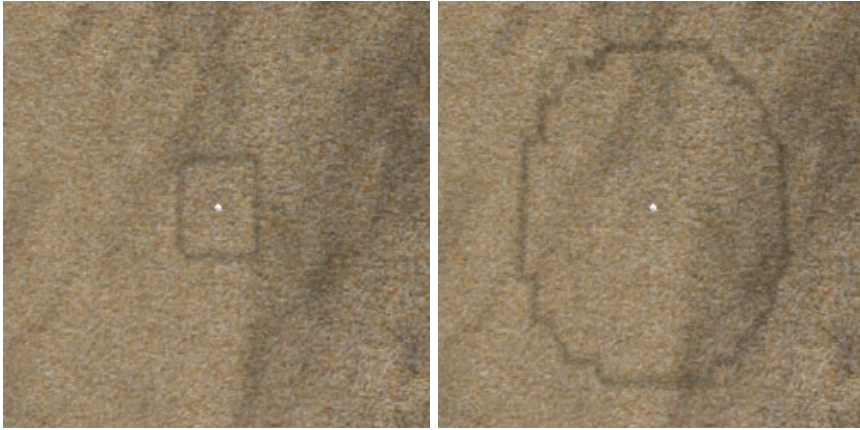
Figura 6.11: Área afectada por una partícula en el escenario del corrimiento de tierra, representada en una malla de 160 \times 160 puntos y 0,1m entre puntos. En la imagen de la izquierda se utiliza \phi = 0,9m en el núcleo de suavizado utilizado para la generación del flujo de velocidades y el área de influencia de las celdas corresponden a un cuadrado con l = 0,5m . En la imagen de la derecha se ha usado un \phi = 0,9m y l = 2,0m .
