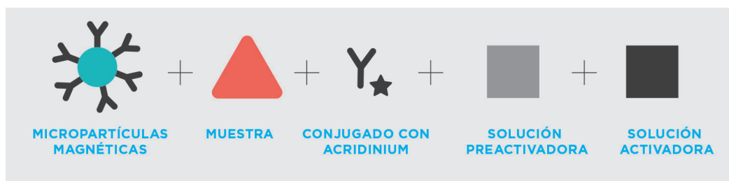
Figura 14 : Componentes del inmunoensayo quimioluminiscente magnético.
