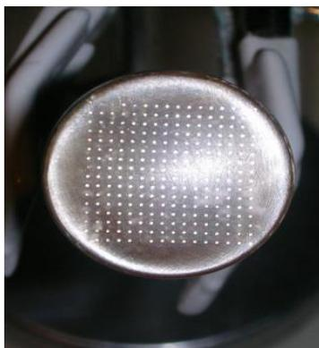
**Figura 2.5.** Electrodo múltiple de registro. En esta imagen se pueden apreciar claramente los 256 electrodos unipolares que forman la placa.
