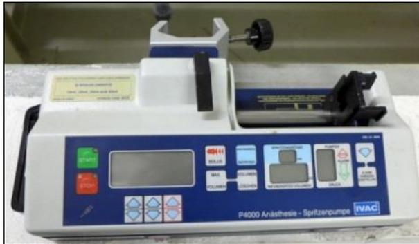
**Figura 2.2.** Bomba de infusión P400 IVAC.
