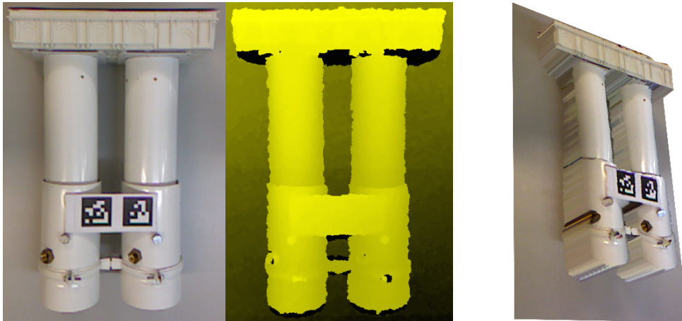
Figura 34. Imagen RGBD (izda.); representación de la imagen con información de profundidad (dcha.)
