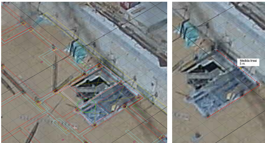
Figura 86. Detalle de la visualización aumentada donde se observa que la información real y virtual aparecen perfectamente alineadas (izda.); medición lineal realizada en el escenario aumentada con los planos ocultos (dcha.)
