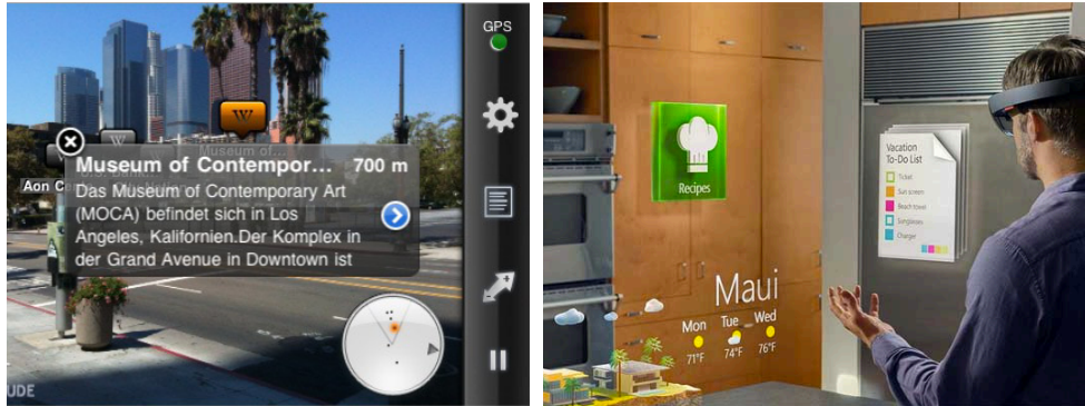
Figura 28. Ejemplo de texto renderizado en 2D de la aplicación Wikitude (izda.), Fuente: www.wikitude.com ; texto asociado a un lugar del entorno real con posición y orientación definidas en 3D en el prototipo de Holo Lens (dcha.), Fuente: [Microsoft. 2015]
