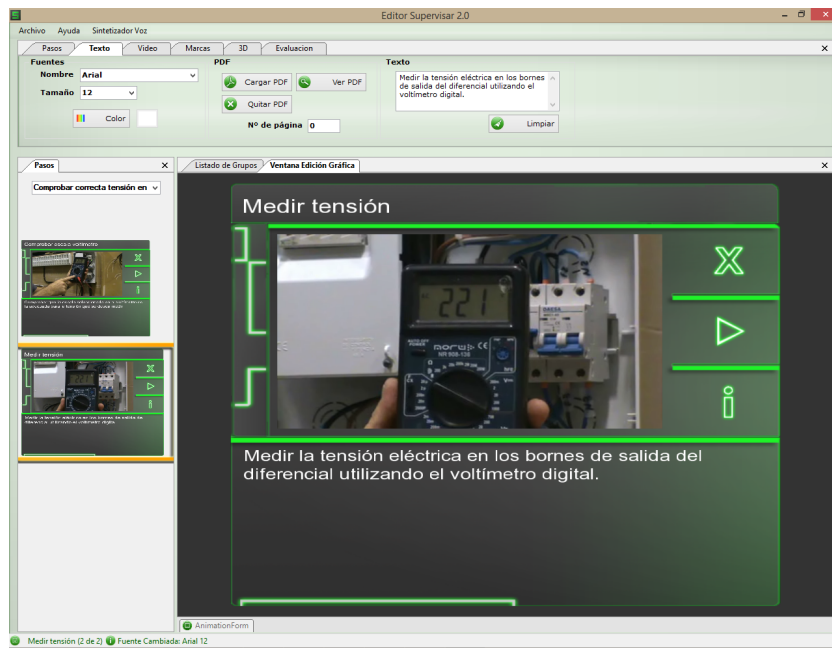
Figura 53. Ejemplo de edición de la información 2D durante la creación de una ayuda visual AR para el mantenimiento de cuadros eléctricos
