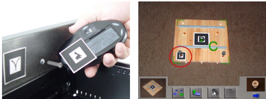
Figura 22. MR Assembly Instructor and Authoring Wizard. Herramienta de posicionamiento de objetos (izda.); visor AR (dcha.). Fuente: [Zauner, et al. 2003]
