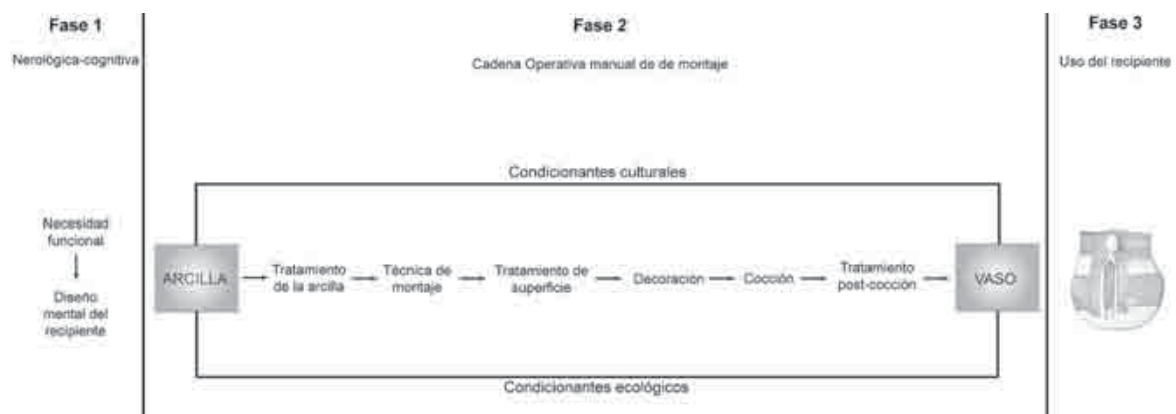
Figura 3.1. Esquema de cadena operativa en el proceso de elaboración de un vaso cerámico.
