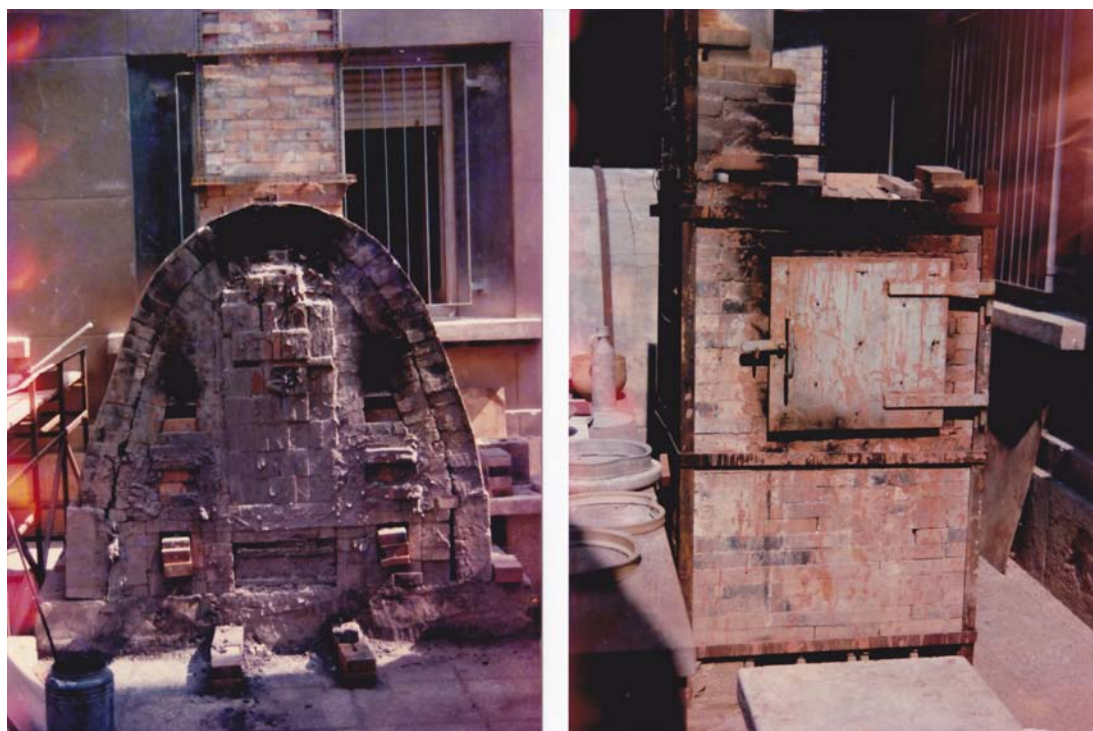
Fotografía 12 y 13 Los hornos de leña en el patio de la Escuela del Grao. (Imagen archivo propio).
