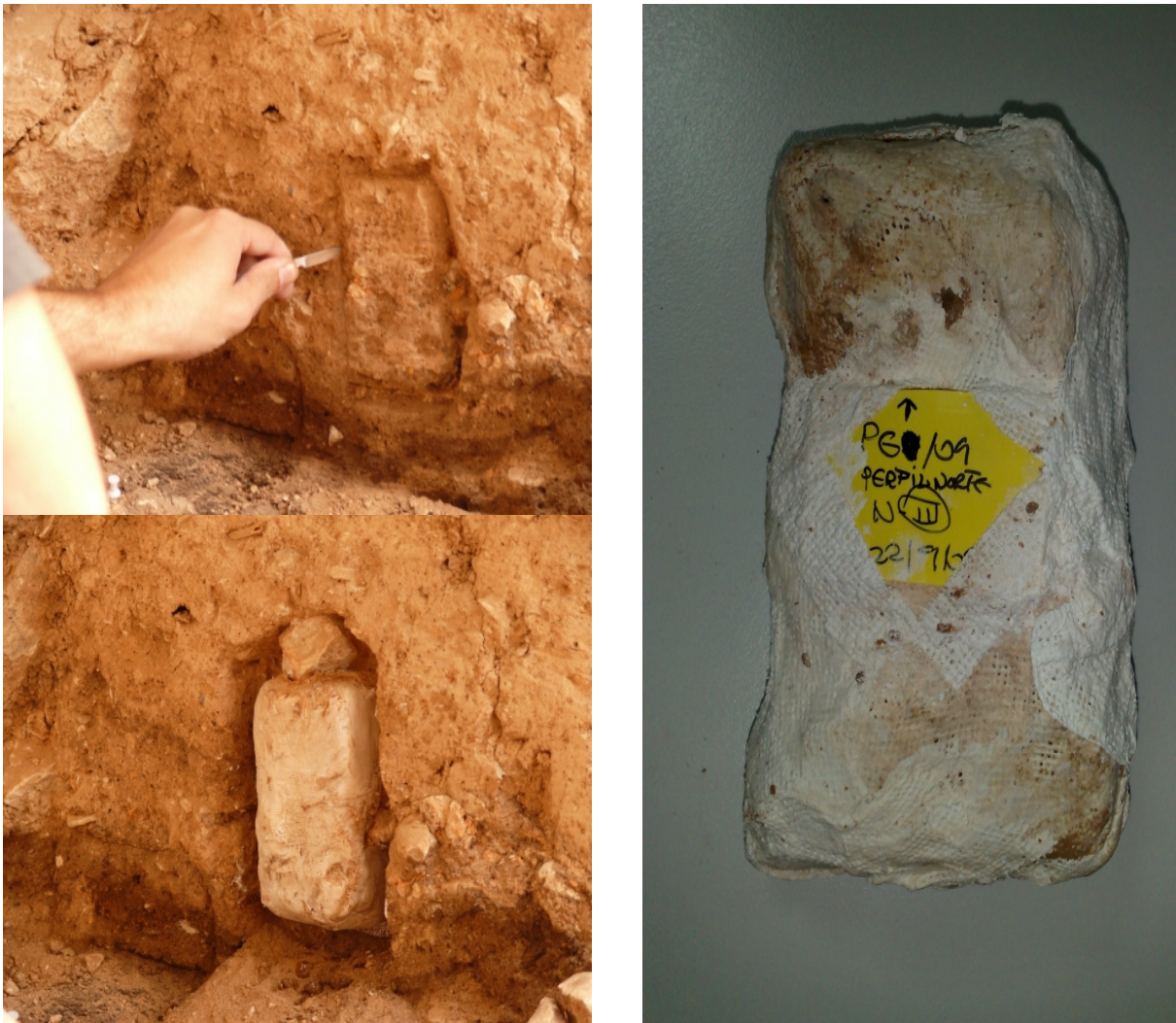
Fig. 2.10. Proceso de extracción de bloque enyesado para la fabricación de lámina delgada de sedimento no perturbado. Fuente: del autor.
