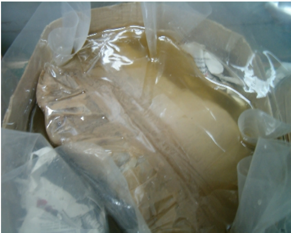
Fig. 2.11. Proceso de impregnación. Fuente: Departamento de Micromorfología de Universitat de Lleida
