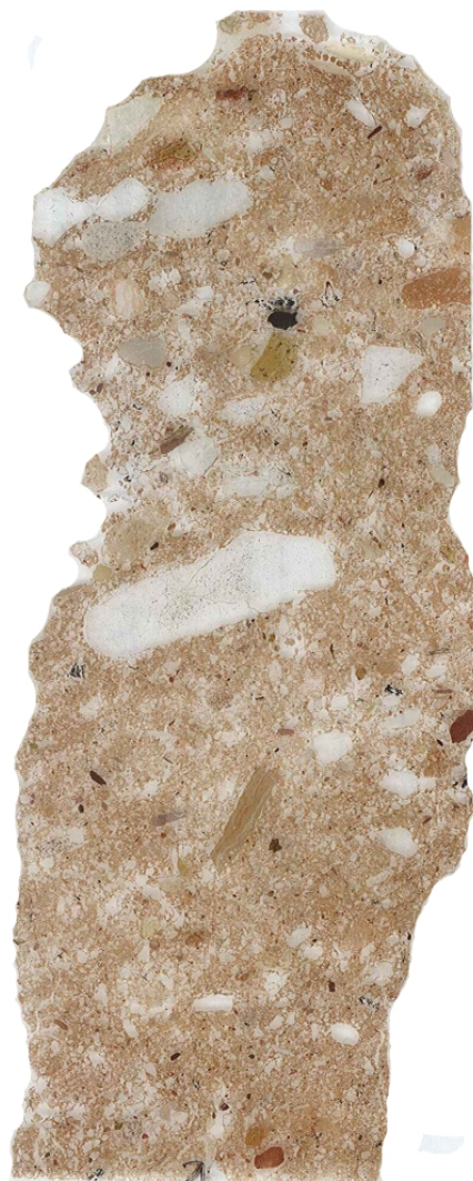
Fig. 2.15. Lámina delgada de material no perturbado. Medidas cristal 13.3x5.6 cm.
