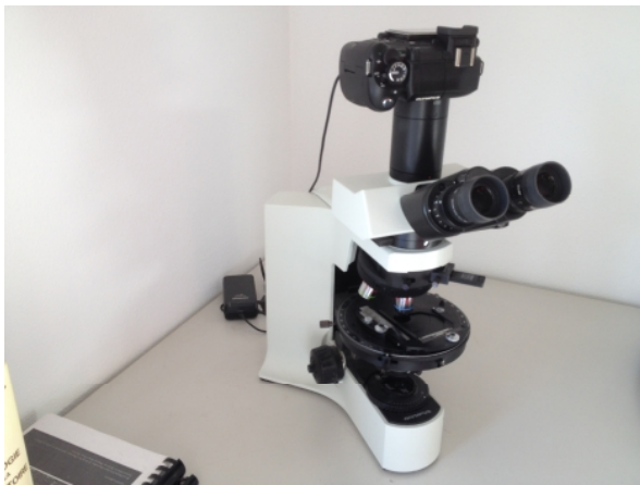
Fig. 2.40. Microscopio petrográfico polarizante propiedad de Estudios de Afección Patrimonial S.L. Fuente: del autor.
