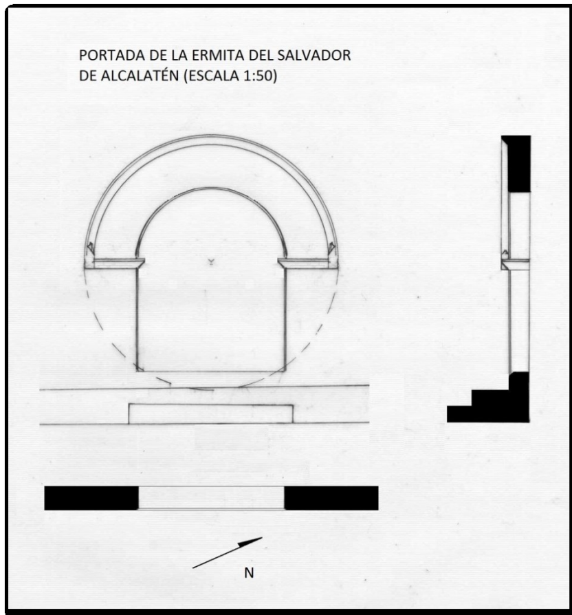
Fig.4. Diseño de la portada en alzado, planta y perfil a escala 1:50 (Francisco J. Soriano).
