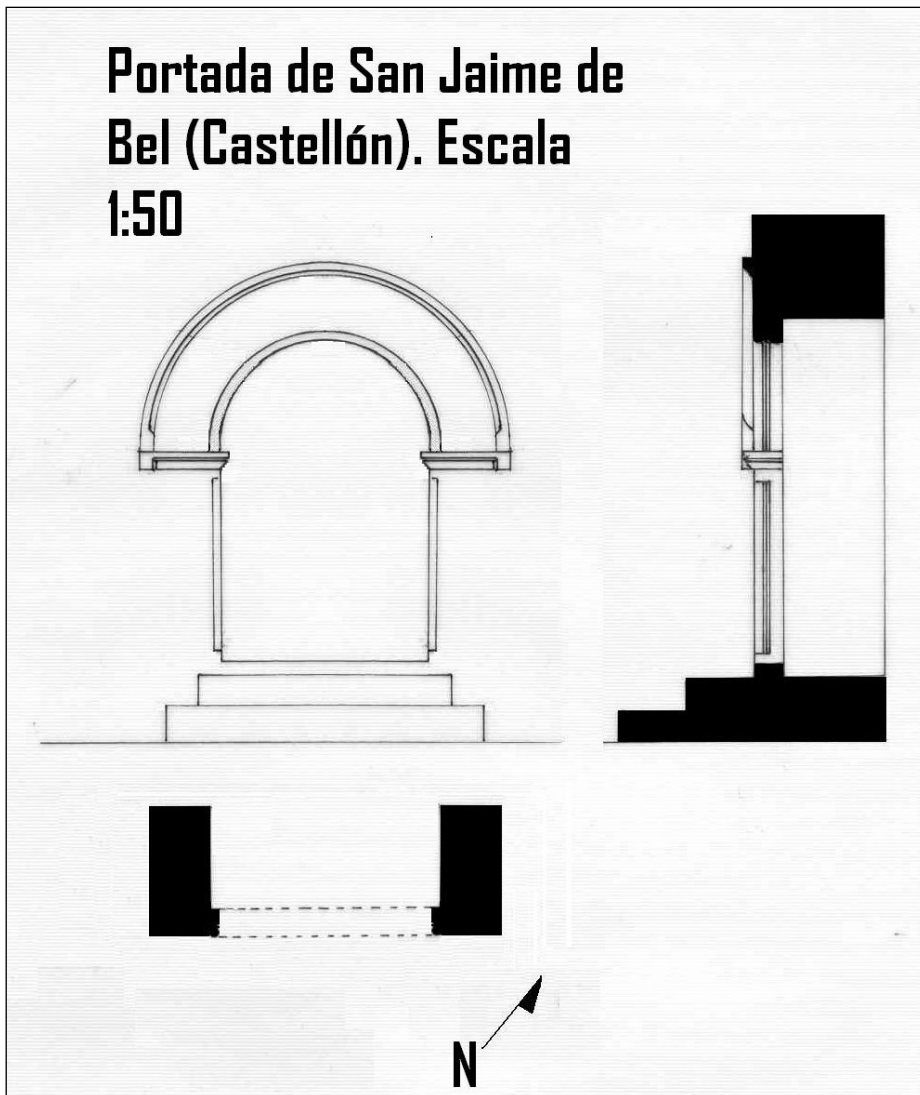
Fig. 7 Diseño de la portada de Bel en planta, alzado y sección (F.J.Soriano).
