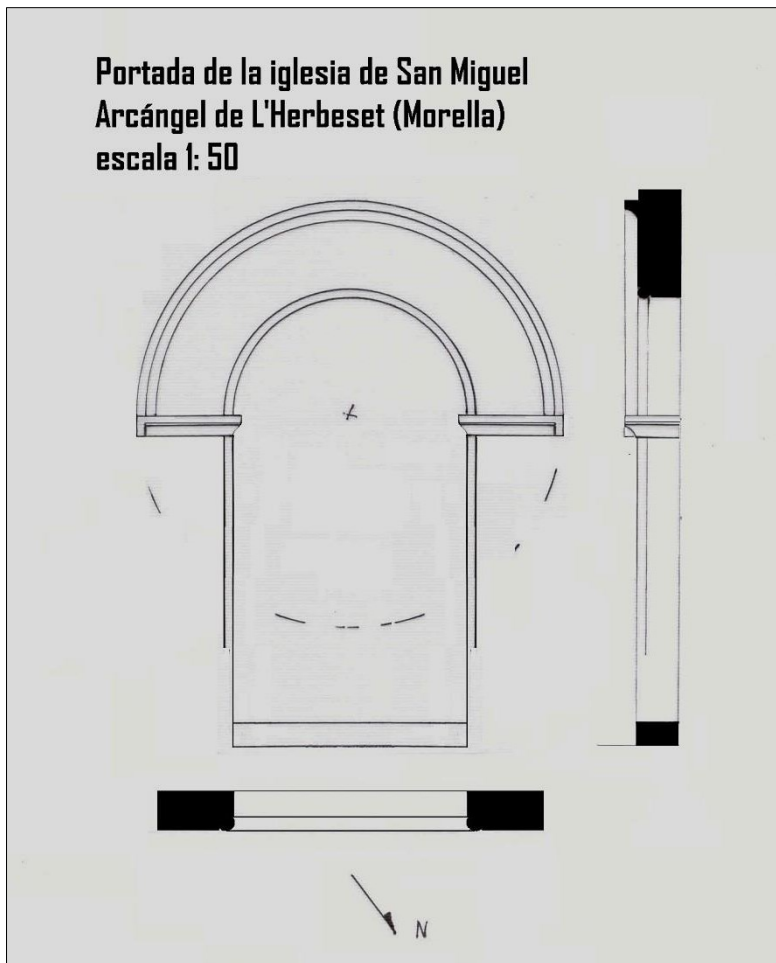
Fig. 6. Diseño reconstructivo de la portada a escala 1:50 ( F. J. Soriano).
