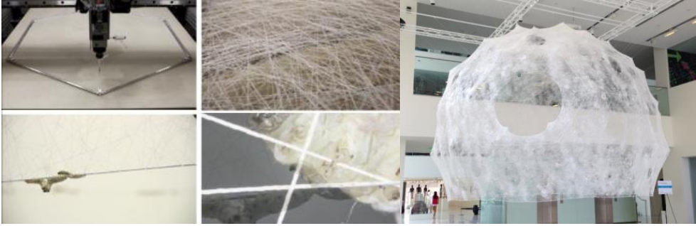
Figura 1.8.- Imágenes del proceso de fabricación de la estructura que simula el Buckminster Fuller , a partir de seda de gusanos.
