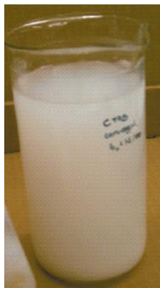
Figura 2.57. Precipitación inmediata ( < 1\text{sec} ) para una biosilice tipo MCM-41 empleando una concentración de TEOS de 0.5M.
