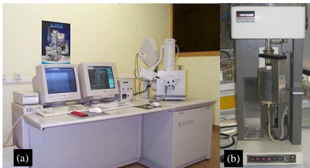
Figura 3.12. (a) microscopio electrónico de barrido PHILIPS mod. XL 30 ESEM con microanálisis EDAX, (b) termobalanza Setaram Setsys 16/18.
