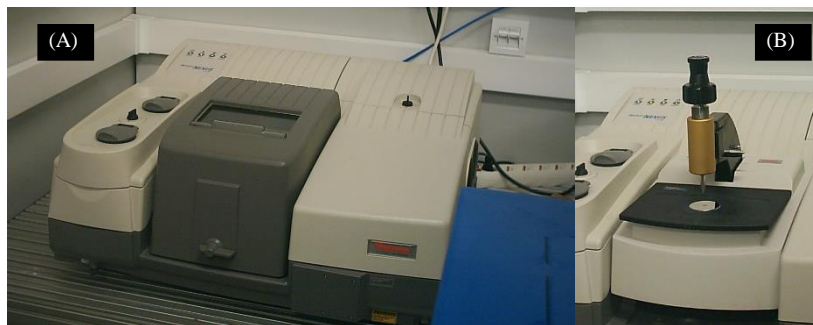
Figura 2.29. (A) Espectrofotómetro FTIR Thermo Nicolete Nexus, (B) accesorio FTIR para Reflectancia Total Atenuada (ATR).
