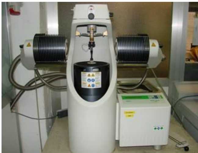
Figura 4.19. Imagen del equipo del Analizador Mecánico Diferencial (DMA) del tipo tipo METTLER DMA 861e.
