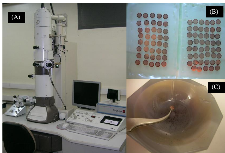
Figura 2.26. (A) Microscopio Electrónico de JEOL JEM-1010, (B) Rejillas empleadas como soporte de la muestra a estudiar, (C) preparación típica de una muestra, mediante deposición por goteo de la dispersión de la muestra a analizar sobre la rejilla de cobre.
