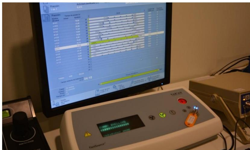
*Imagen 45. Comprobación de canales mediante fuente dummy*
