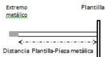
*Imagen 44. Distancia entre el template y extremo de conexión de aguja al transfer*
