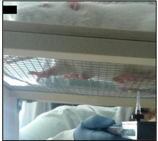
**FIGURA 13. (A) APARATO ELECTRONIC VON FREY: CONSTA DE UN TRANSDUCTOR DE FUERZA, UNA UNIDAD ALMEMO 2290-4 DE REGISTRO DE DATOS Y UN DISPOSITIVO DE REINICIO; (B) RATA SOBRE LA REJILLA ELEVADA. LA PUNTA RÍGIDA UNIDA AL TRANSDUCTOR DE FUERZA EJERCE PRESIÓN SOBRE LA PATA TRASERA DERECHA.**
