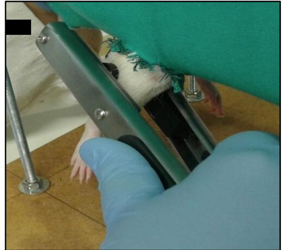
**FIGURA 14. (A) APARATO RANDALL Y SELITTO ADAPTADO: CONSTA DE UN TRANSDUCTOR DE FUERZA, UNA UNIDAD ALMEMO 2290-4 DE REGISTRO DE DATOS Y UN DISPOSITIVO DE REINICIO; (B) RATA SOBRE EL SOPORTE DE TELA CON LAS PATAS SUSPENDIDAS. EL TRANSDUCTOR DE FUERZA UNIDO A UN APARATO EN FORMA DE PINZA EJERCE PRESIÓN SOBRE EL MÚSCULO GASTROCNEMIO LA PATA TRASERA DERECHA.**
