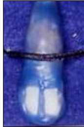
Figura 2.30. Muestras dentales sumergidas en cera resistente al ácido y con dos ventanas sin cubrir; una de las ventanas servía como control y la otra fue irradiada con láser de Nd:YAG.
