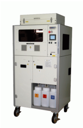
Figura 1. Sistema HANABI PI de procesamiento automático de muestras para análisis citogenético.
