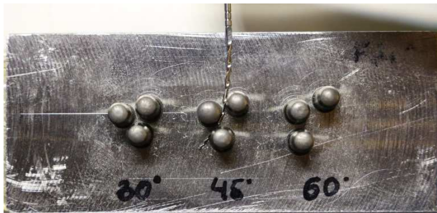
Il·lustració 24: Fotografia del dispositiu per a la llima F360#25 (curvatures de 30°, 45° i 60°)
