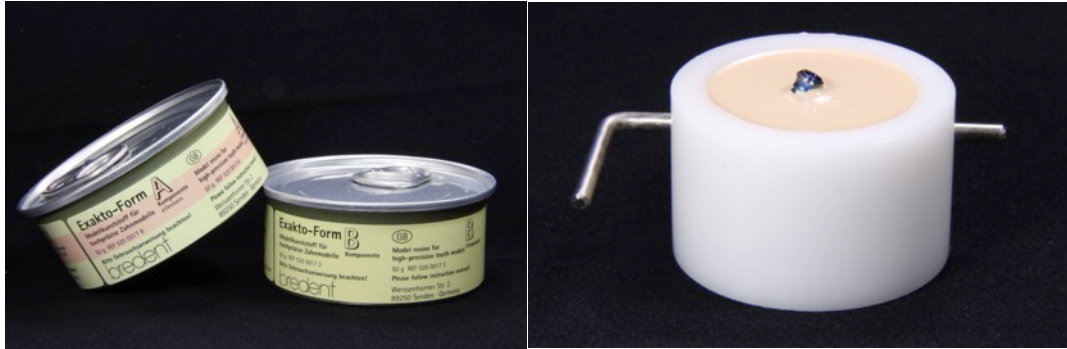
Figura 4.13. Resina epoxi Exacto-Form (componentes A y B). Implante embebido en probeta de nylon con una angulación de 30\pm 2^\circ sobre la vertical de aplicación de la carga.
