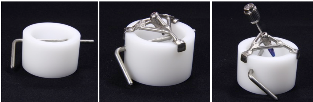
Figura 4.12. Probeta de nylon con el vástago de acero que actúa de sistema antirotacional. Llave colada colocada sobre la probeta de nylon. Llave colada con el implante atornillado.
