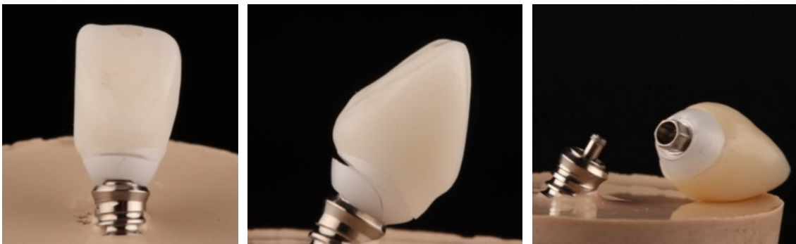
Figura 5.4: tipos de fractura del grupo PCCE: A1 y A2) Fractura del pilar sin fractura de la corona espécimen PCCE13. B) Fractura del tornillo espécimen PCCE10.
