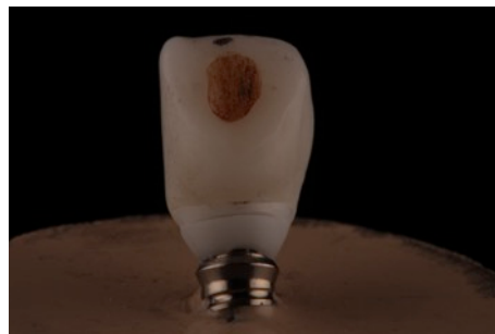
Figura 5.1: Marca de la indentación del puntero sobre la cerámica.
