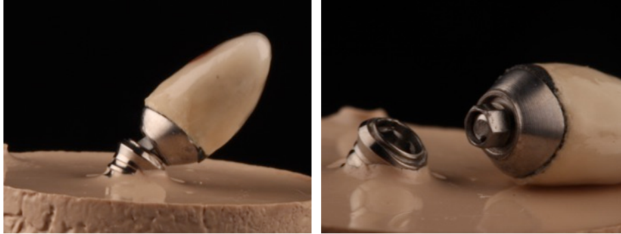
Figura 5.2: tipos de fractura del grupo PTCM. En todos los especímenes se produjo la fractura a nivel del tornillo de fijación protésica.
