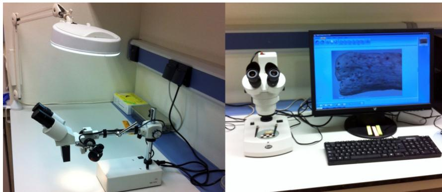
Fig. 16. Stereomicroscope BMS SL-40 (izquierda) y Digital stereomicroscope Motic DM-143-FBGG-B (derecha) empleados en la presente Tesis Doctoral.
