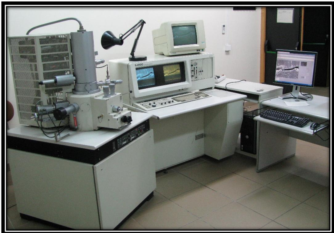
*Figura 71. Microscopio electrónico de barrido.*
