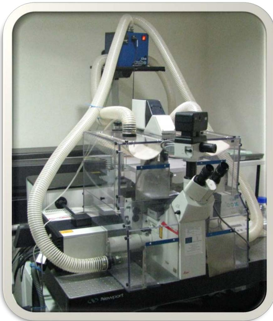
*Figura 66. Microscopio confocal láser de barrido.*
