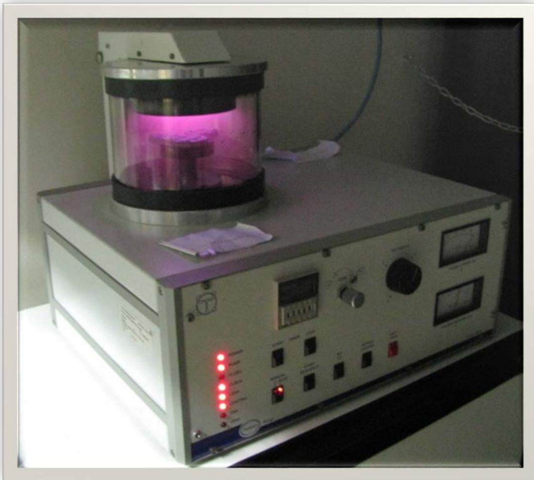
*Figura 69. Revestidor de bombardeo iónico.*
