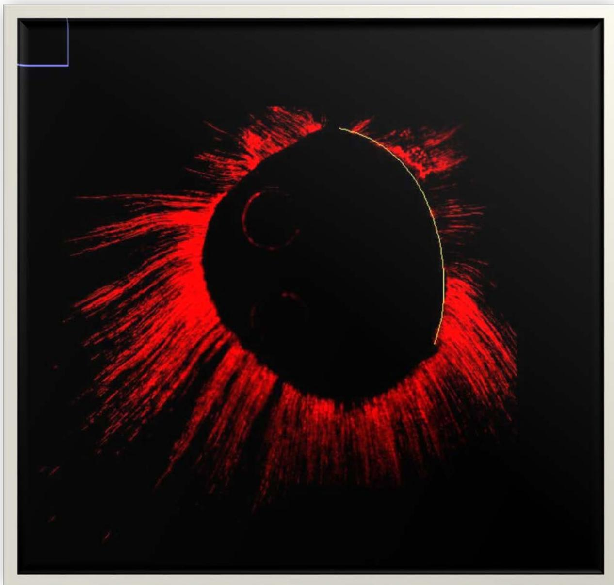
*Figura 73. Cálculo penetración parcial de la Rodamina B en muestra C1 medio.*
