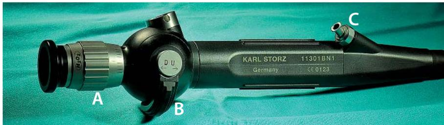
**Figura 4.** Cabeza de un fibroscopio flexible. A: ajuste de dioptrías y enfoque del visor. B: palanca de control. C: entrada del canal de trabajo.
