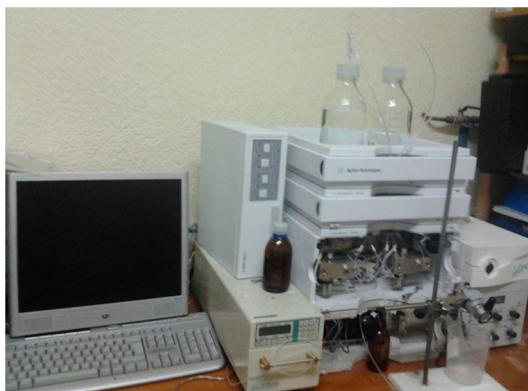
Figura 29. Sistema para realizar nano-LC-DAD.
