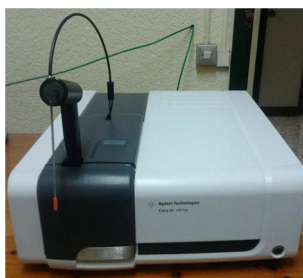
Figura 20. Espectrofotómetro UV-Vis Cary 60 equipado con una fibra óptica.
