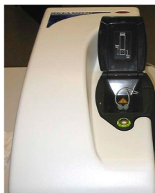
Figura 22. Sistema Zetasizer Nano ZS para realizar el análisis por DLS.
