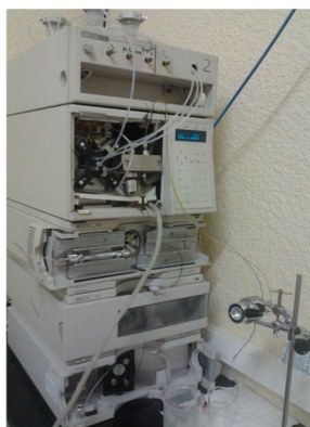
Figura 27. Sistema HPLC-FLD con compartimento termostatzado para la columna analítica.
