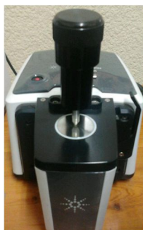
Figura 23. Accesorio FTIR 630 que permite la obtención de espectros en el MIR.
