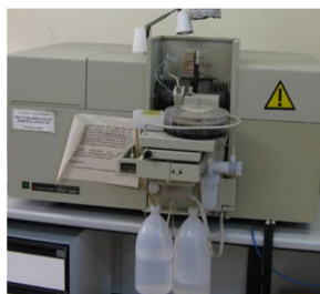
Figura 21. Espectrómetro Perkin Elmer 4100 ZL (Zeeman) equipado con una cámara de grafito.
