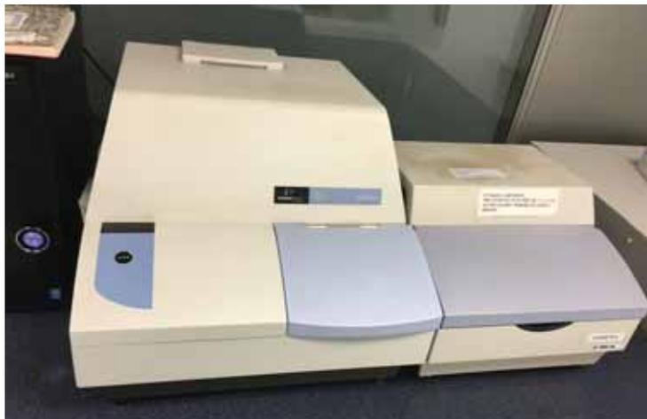
Fig. 18. Espectrofotómetro utilizado para el análisis del RANKL y Osteoprotegerina.
