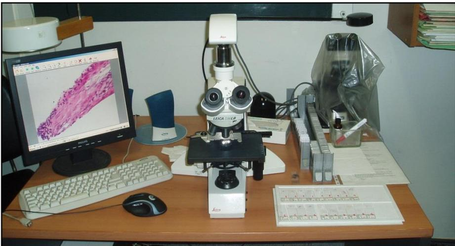
Figura 20. Microscopio óptico Leica modelo DFC320 y sistema digital de captación de imágenes.
