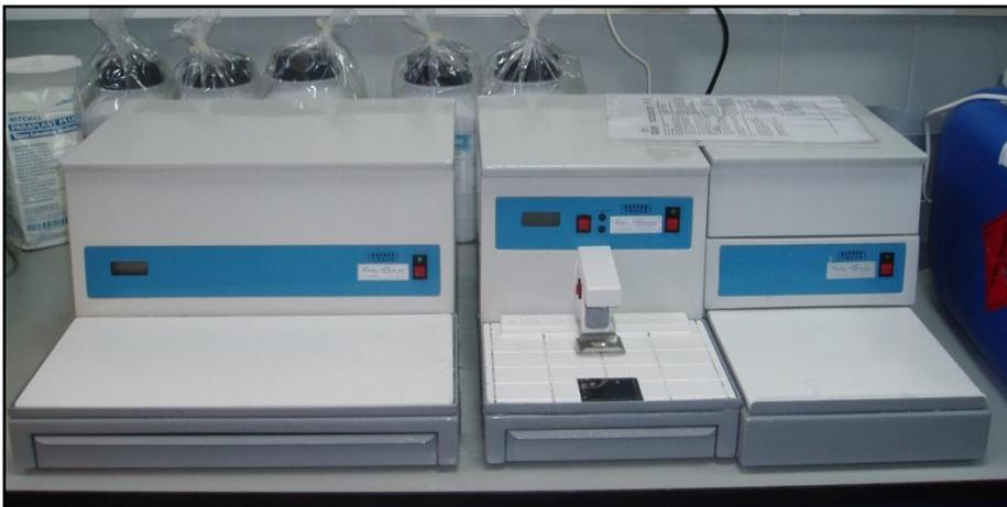
Figura 18. Sistema de montaje para inclusión en parafina, modelo Oxford Trade.
