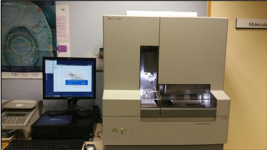
Figura 21. Secuenciador capilar 3130 Genetic Analyzer.
