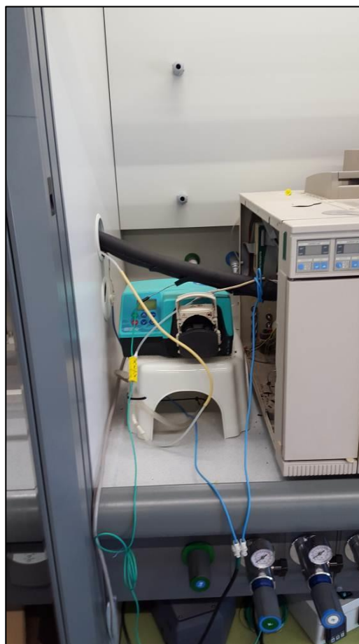
b) Bomba peristáltica para la corriente vapor
