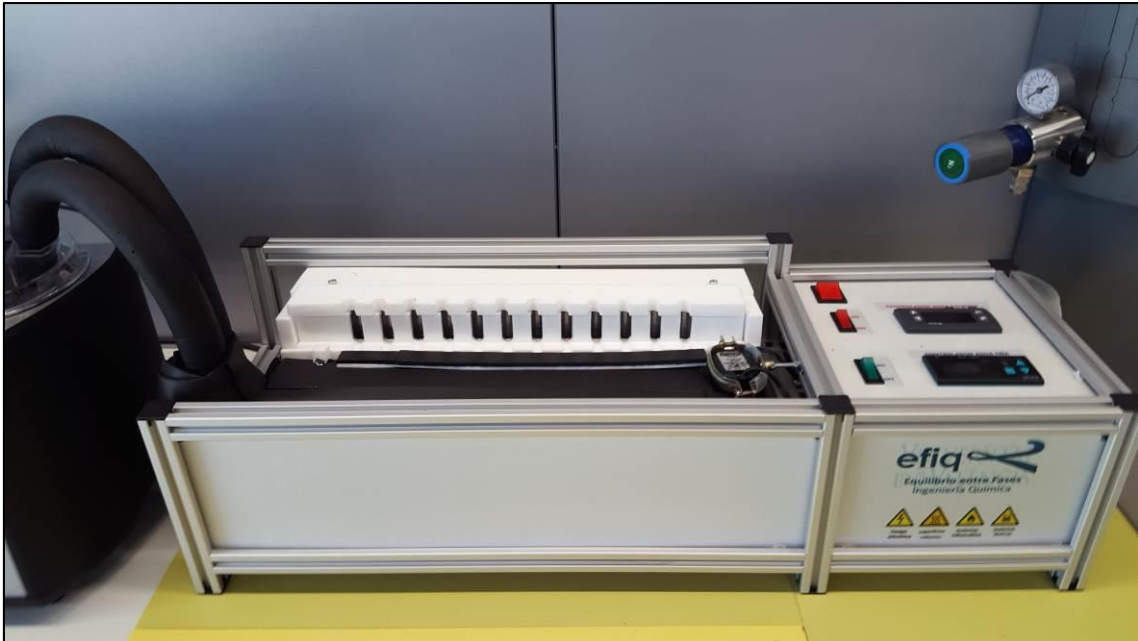
Figura 5.12 Equipo de microdestilación utilizado en la determinación experimental del ELLV
