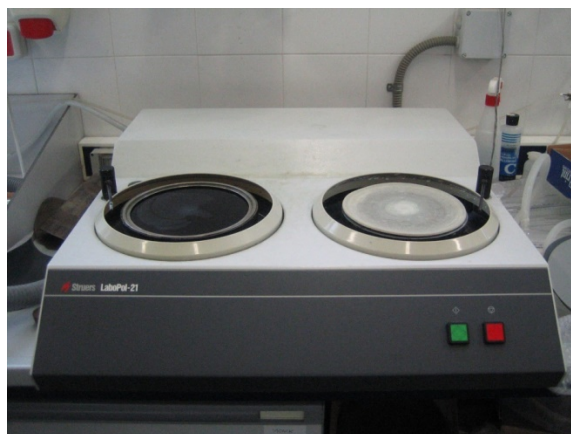
Figura 20. Lijadora/Pulidora Struers Labopol-21
