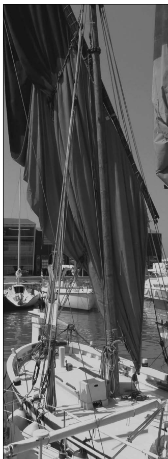
Fig. 8: La drizza rinviata al capodibanda della fiancata destra nel lancione Saviolina del 1928 (foto di S. Medas).
