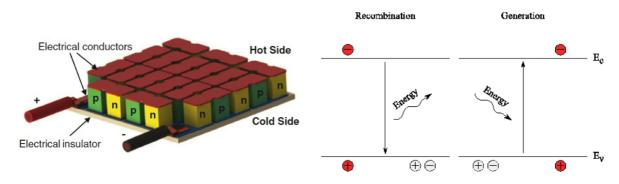
En el modo de refrigeración termoeléctrica, la placa superior del módulo se enfría porque en las uniones p-n que están en contacto con ella se produce la generación de pares electrón-hueco. Tomando energía de dicha placa, un electrón de la banda inferior (o de valencia) del material tipo p se excita a la banda superior y migra, por efecto del campo eléctrico aplicado, al material tipo n. En el material tipo p queda un defecto de electrón o hueco que es el portador de carga efectiva en el mismo.
