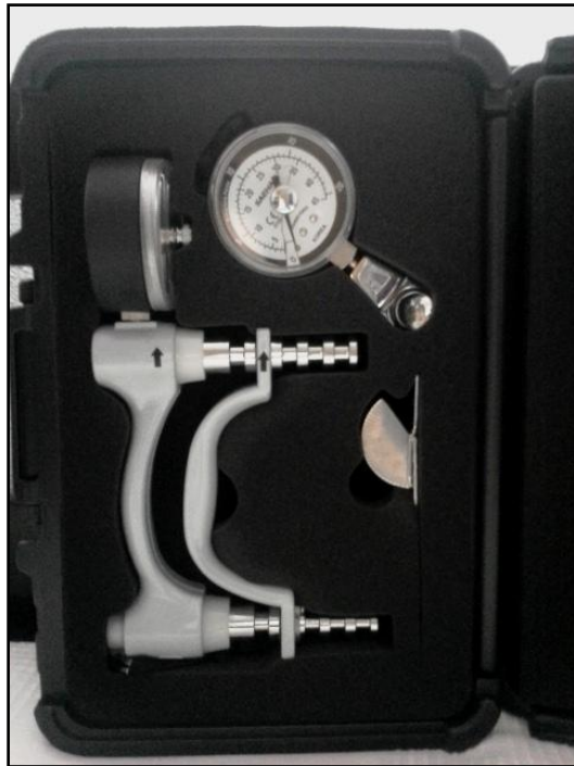
Figura II.8. Dinamómetros analógicos para valorar la fuerza isométrica de empuñadura y pinza.
