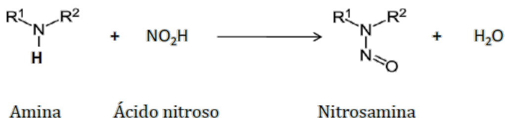
Figura 2. Reacción de formación de nitrosaminas a partir de las aminas. Obtenida de http://www.hablandodeciencia.com/articulos/2013/01/28/cuidado-con-las-aminas/
