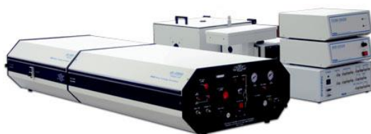
Figura 4.4. Espectrofluorímetro acoplado al laser de nitrógeno.
